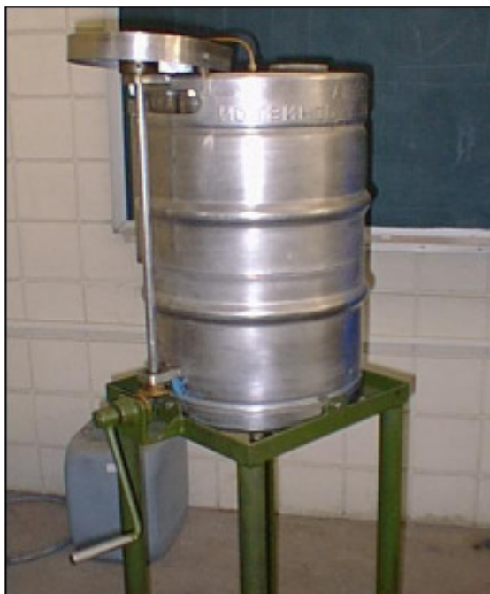
Manueller Biodieselreaktor aus peruanischer Fertigung (Foto: Fernando Acosta, ITDG-Soluciones Prácticas)
